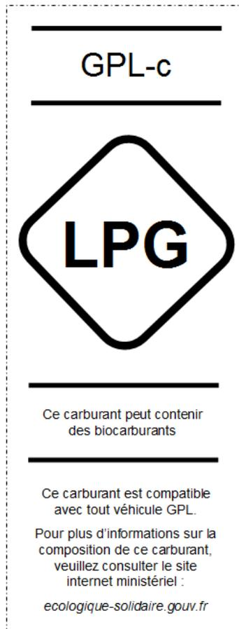
Il devra également être disposé sur le pistolet de l'appareil distributeur un étiquetage spécifique qui est présenté ci-dessous, d'une largeur minimum de 1,5 cm :
